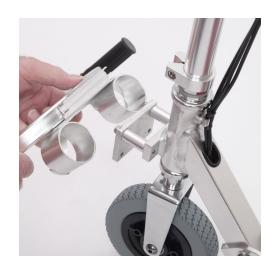
1.) Fußstützen durch Lösen der zwei Schrauben wegnehmen und durch die Verlängerungsplatte ersetzen
